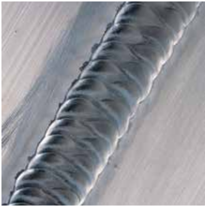
採用 Alulinx 氣體的 10mm 厚 4140 鋁合金 TIG 對鐸
