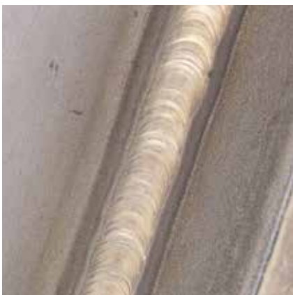
採用Inolinx TIG(鎢極惰性氣體保護銲)氣體的3mm沃斯田鐵不銹鋼鋼板PB MAG (141) 角銲
