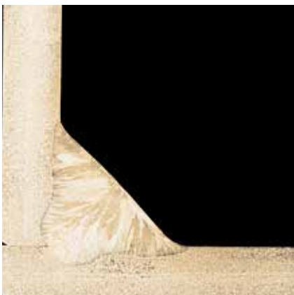
採用Inolinx MAG氣體的3mm沃斯田鐵不銹鋼鋼板PB MAG (135) 角銲
