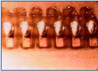
在空氣氣氛中回流，較差的浸潤性和較多的助焊劑殘留。
