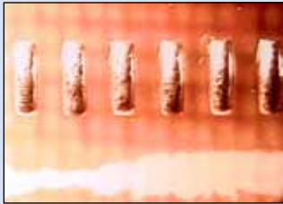
在氮氣氣氛中回流，良好的浸潤性和幾乎沒有助焊劑殘留。
