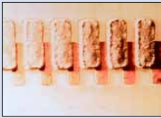
在印刷電路板焊板上印刷移位的錫膏。
